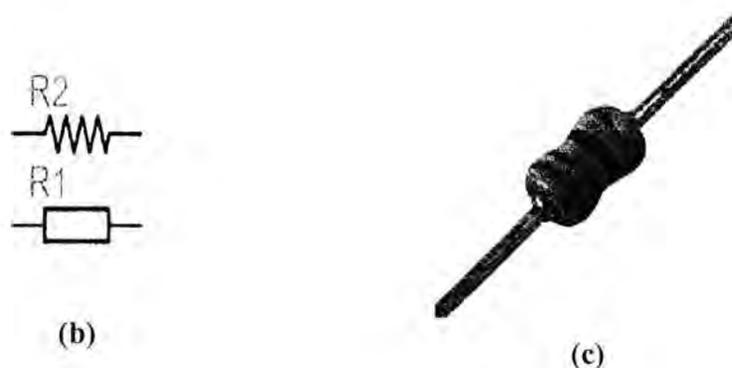
Gambar 3.1(a) Kode warna tahanan , (b) Simbol tahanan , (c) Gambar tahanan
