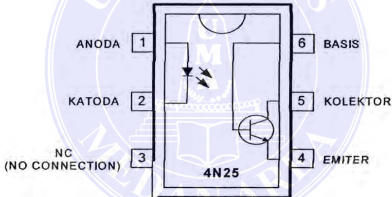
Gambar 2.8 Konfigurasi Pin Optocoupler 4N25
