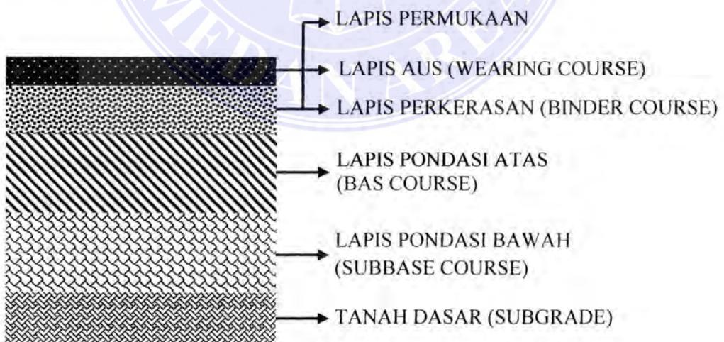
Gambar 2.2 Susunan Konstruksi Perkerasan Lentur
