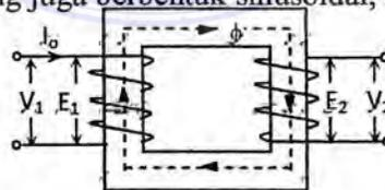
Gambar 2. 20 Prinsip kerja transformator
