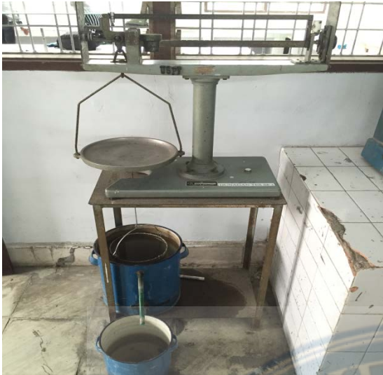
Dunagan Test Menimbang Berat Jenis Agregat Kasar
