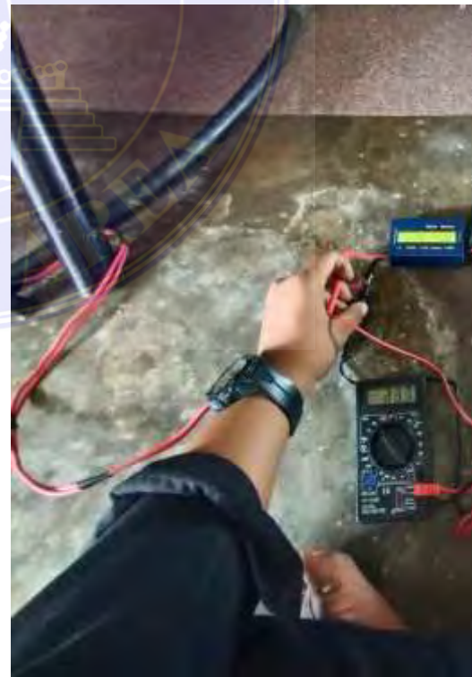
Lampiran 2. Pengukuran Pengambilan Data Tidak Terdapat Beban Dengan Multimeter
