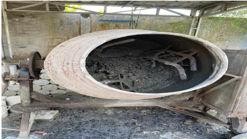
Gambar 10. Proses pencampuran pasir, kerikil, semen dan air
