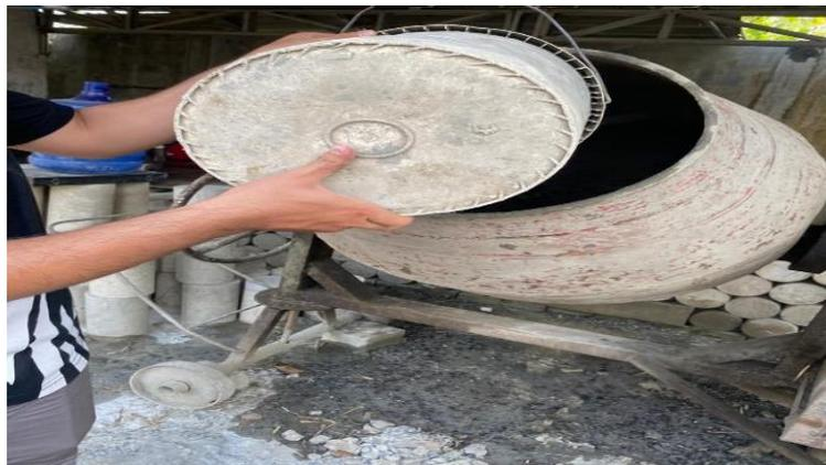
Gambar 9. Proses pemasukan pasir (Dokumentasi Laboratorium, 2023)
