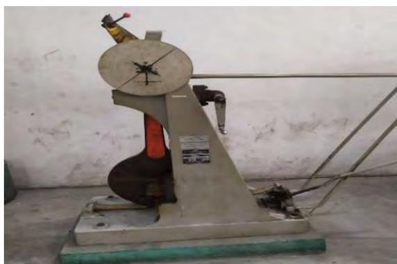
Gambar 3.1. Alat Pengujian Impak.
