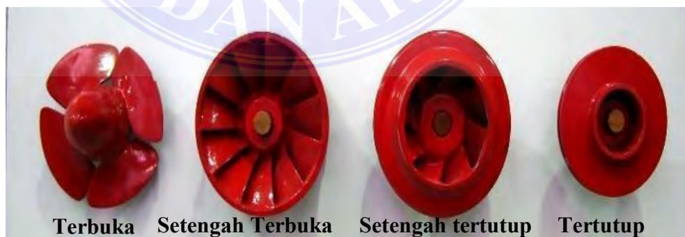
Gambar 2. 10. Bentuk *impeller* pompa
