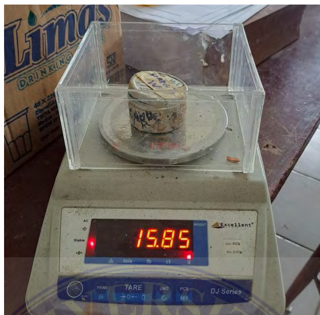
Setelah 24 jam di oven cawan + uji tanah di timbang kembali
