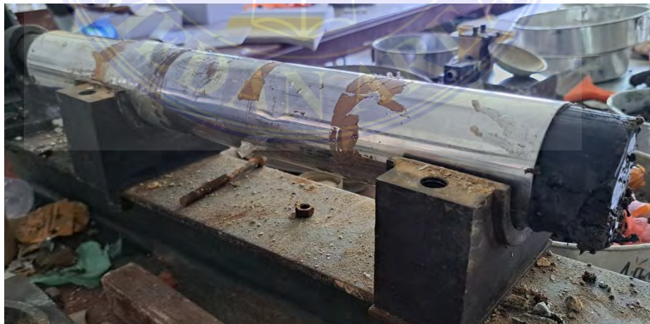
Keluarkan sampel uji menggunakan extruder dan masukkan ring direct shear kedalam sampel tanah
