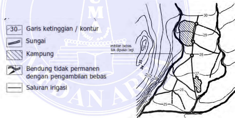
Gambar 2. Jaringan irigasi semi teknis (Standar Perencanaan Irigasi KP-01, 2013)
