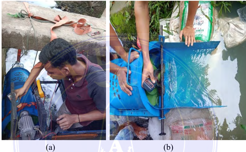
Gambar 3.12 Pengukuran Putaran Generator (a) dan Poros Turbin (b)
