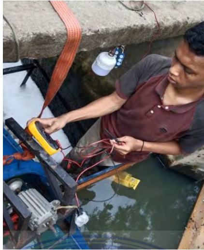
Gambar 3.13 Pengukuran Tegangan dan Kuat Arus
