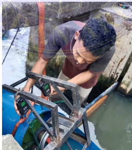
Gambar 3.14 Pengukuran Gaya Pengereman pully pada poros turbin
