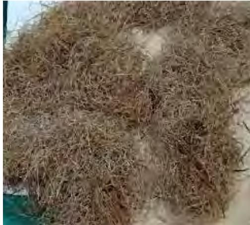
Gambar 2. 8. Serat Pelepah Sawit
