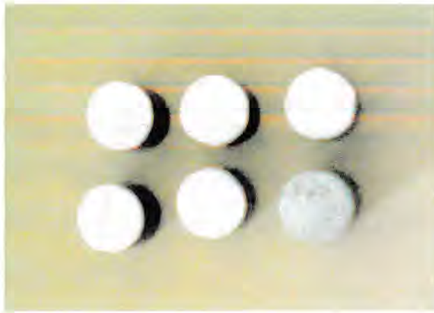
Gbr. 3.2. Contoh Benda Uji Struktur Mikro dan Kekerasan
