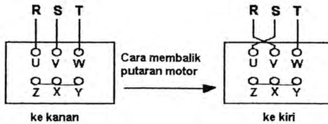
Gambar 2.4 Cara membalik putaran motor.
