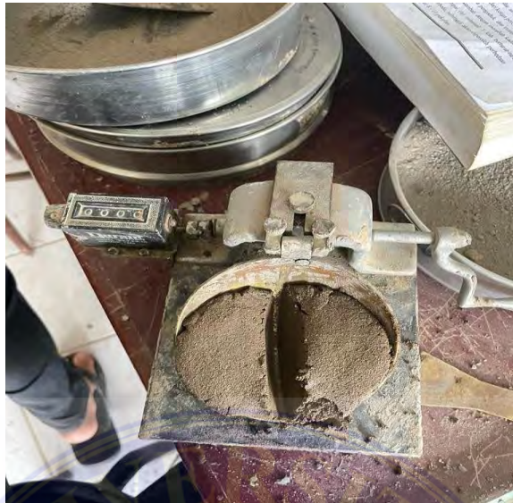
Pengujian batas cair
