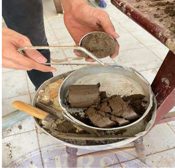
Pencetakan sampel ke ring direct shear
