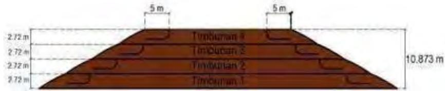
Gambar 6. *preloading* secara Bertahap (Braja M. Das, 1993)
