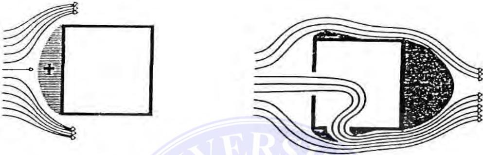
7.1 Bila Angin menerpa sebuah Bangunan, maka terbentuk sebuah daerah bertekanan tinggi pada sisi hulu angin.
