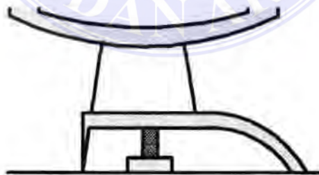
Gambar 2.9 Impeler Jenis Propeler
