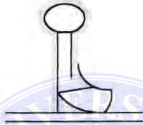
Gambar 2.6 Impeller Jenis Radial
