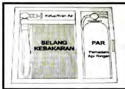
Gambar: 5.26. Hydrant di dalam Gedung
