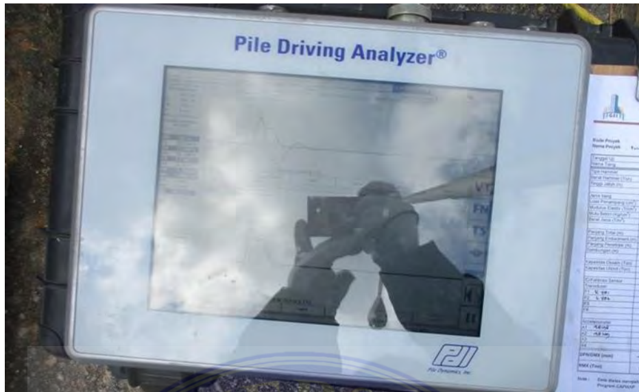
Gambar 11. Tampilan monitor alat PDA ters pada saat melakukan pengujian PDA ( pile drive analysis )
