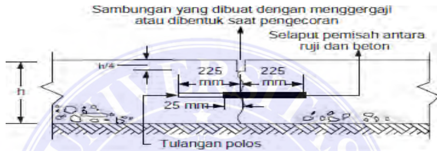
b. Sambungan susut melintang dengan dowel
