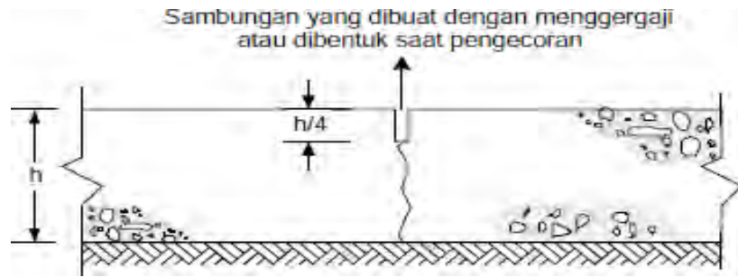
a. Sambungan susut melintang tanpa dowel
