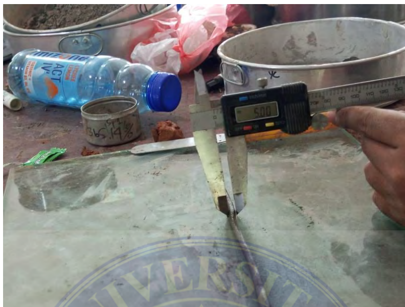
Gambar 6. Pengujian Batas Plastis
