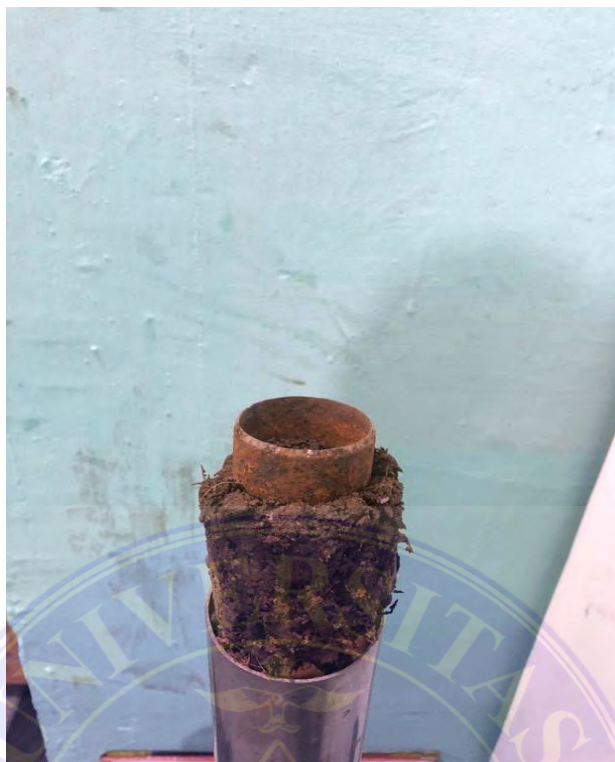
Masukkan Ring Ke Sampel tanah yang dikeluarkan dari extruder
