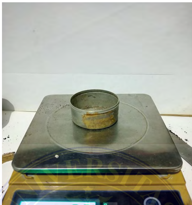
Timbang krus menggunakan timbangan digital dengan ketelitian 0,009
