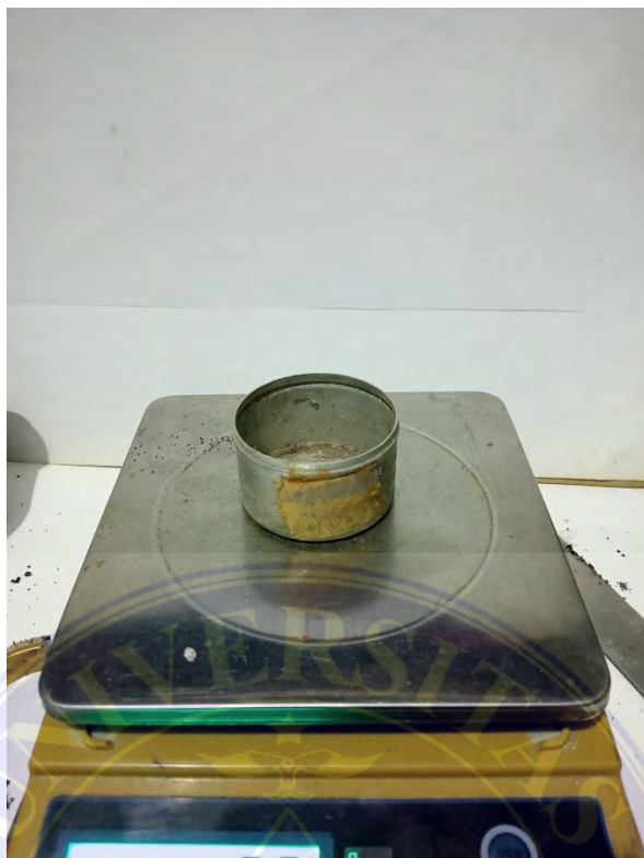
timbang krus dengan timbangan digital ketelitian 0,1 gr
