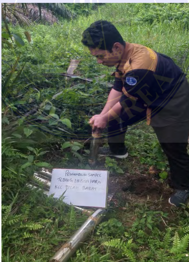
Pengambilan sampel uji menggunakan tabung stainless untuk tanah uji yang tidak terganggu.
