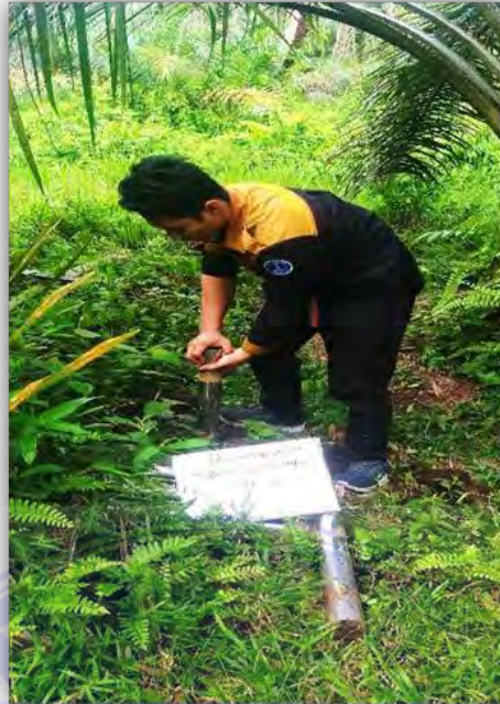
Gambar 9. Pengambilan Sampel Tanah tidak terganggu ( Undisturb Soil ) (Dokumentasi Peneliti, 2023)
