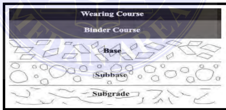
Gambar 1. Struktur Perkerasan Jalan Lentur (Gatot Rusbintardjo, 2003)
