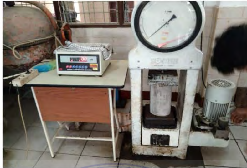
Pengujian Kuat Tekan Beton (Penelitian, 2023)
