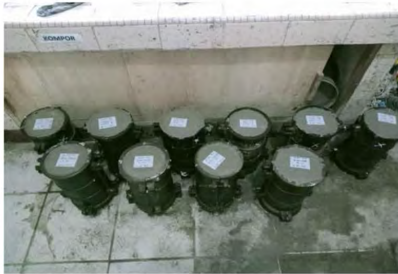
Beton segar setelah dimasukkan ke dalam cetakan silinder (Penelitian, 2023)
