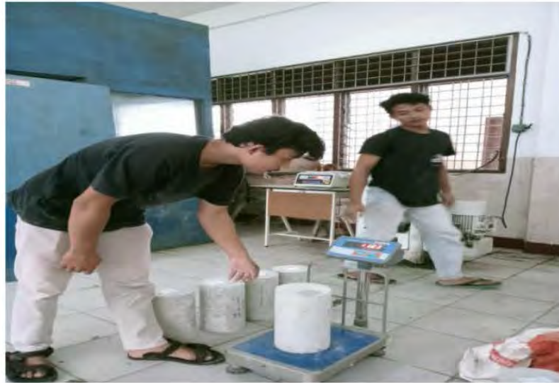
Penimbangan benda uji sebelum uji kuat tekan (Penelitian, 2023)
