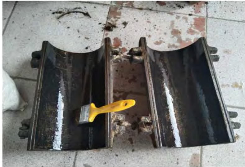
Pengolesan miyak pada cetakan (Penelitian, 2023)
