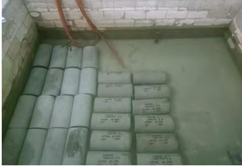
Perawatan benda uji dengan cara perendaman (Penelitian,2023)
