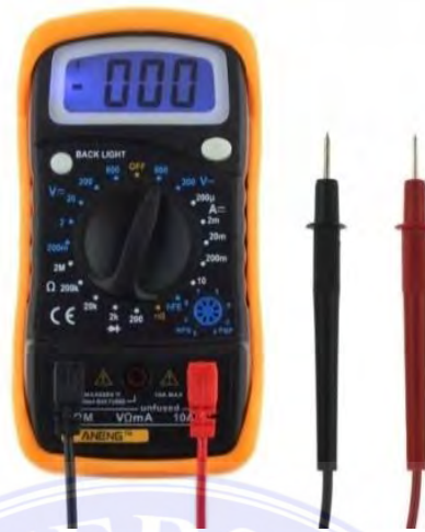
Gambar 3.3 AVO meter untuk mengukur kuat arus
