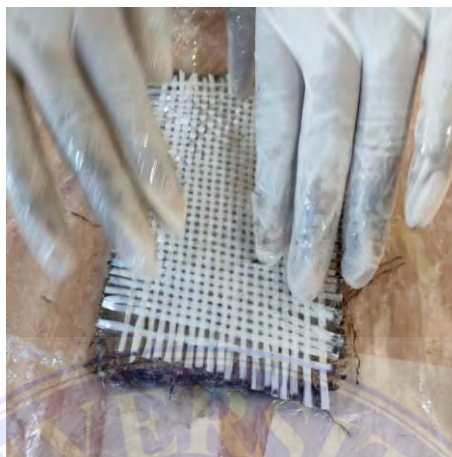
Gambar 3. 13. Pelapisan Susunan Komposisi Laminat
