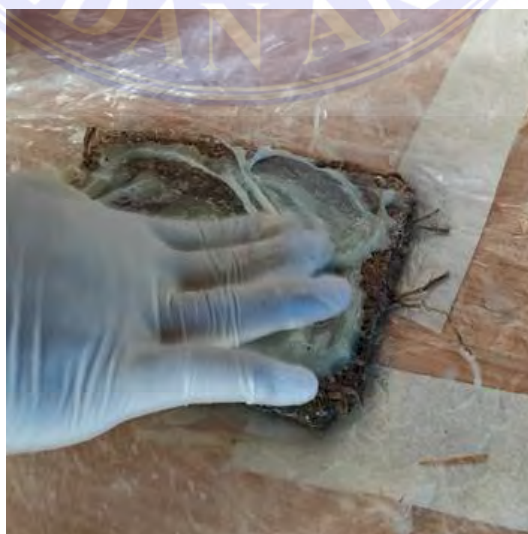
Gambar 3. 12. Pemberian Epoksi pada Jute Anyaman
