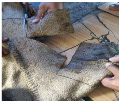
Gambar 3. 10. Pemotongan Lembar Jute
