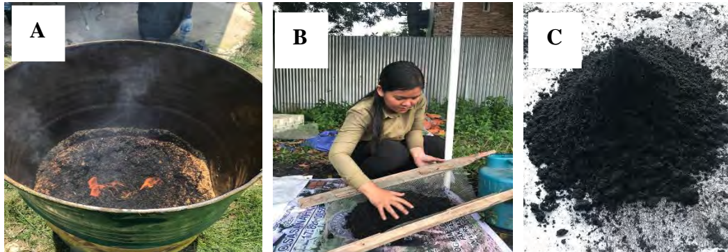
Gambar 1. Pembuatan biochar sekam padi A). Pembakaran sekam padi, B) Penghalusan biochar, C) Biochar sekam padi yang sudah halus
