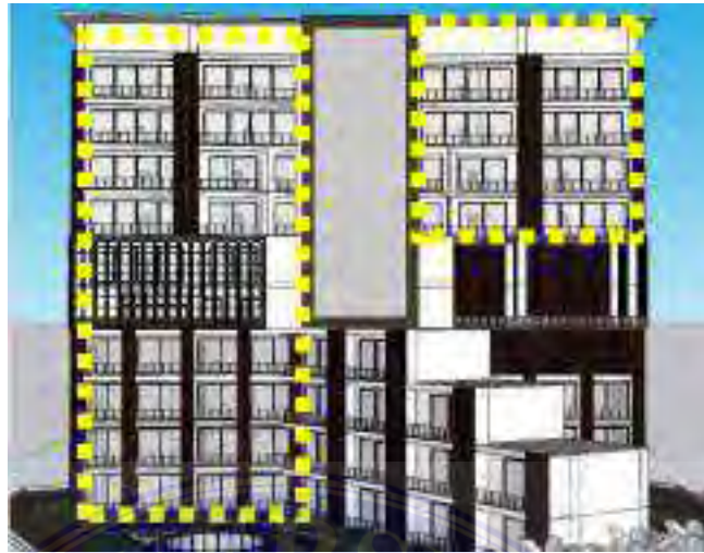
Gambar 5. 8 Alat Pembayang Pasif dan Balkon
