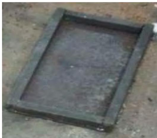
Gambar 3.17. Cetakan die casting
