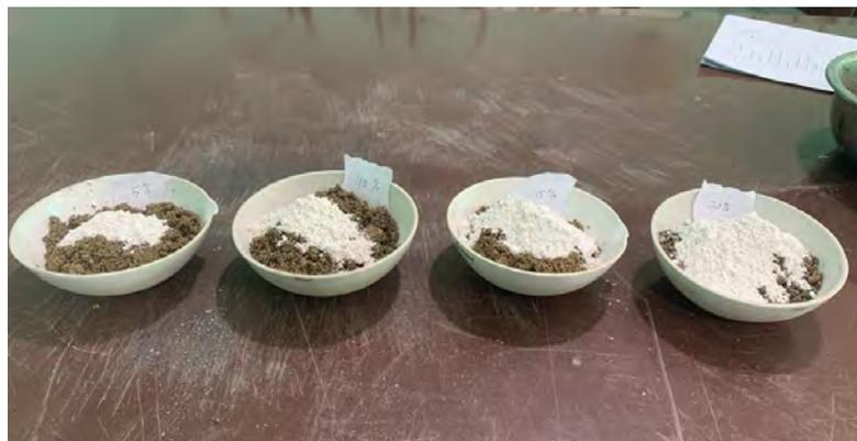
Gambar 11. Sampel uji Di Campur kapur *Gypsum*
