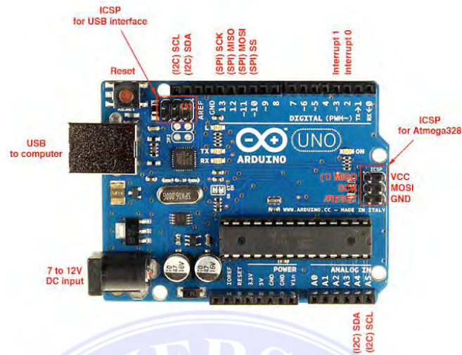
Gambar 2. 4 Bagian- bagian Arduino uno
