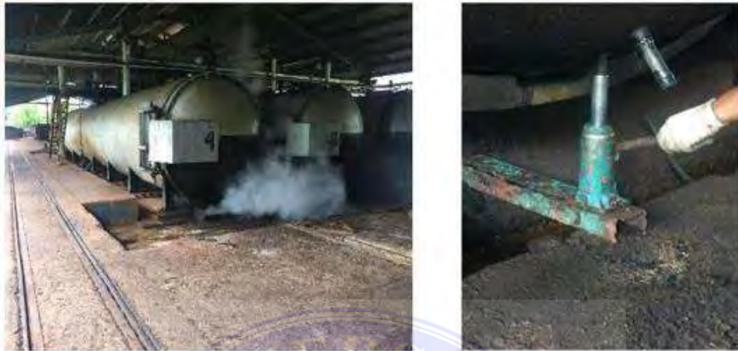
Gambar 2.7. Dampak dan solusi kondisi pintu yang tidak sejajar
