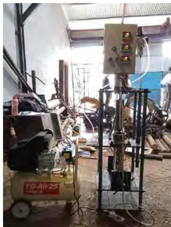
Gambar 3.2. Mesin *plastic injection molding vertical* menggunakan sistem pneumatik dengan volume cetakan  $300 \text{ cm}^3$
