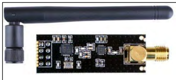
Gambar 2.3 Modul transceiver NRF24L01 PA+LNA Sumber : (Hebi, Ray dan Tamal, 2023)
