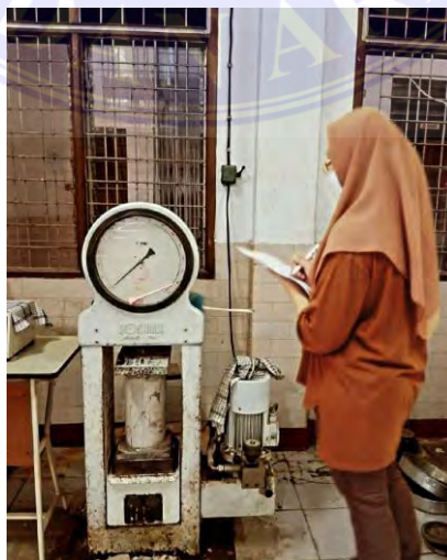
Uji kuat tekan beton
