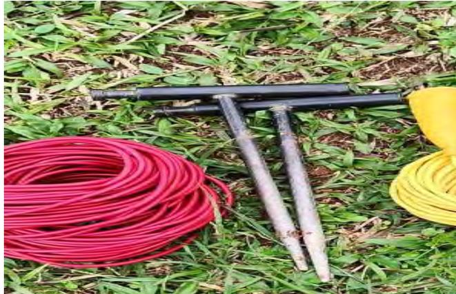
Gambar 3.5 : Elektroda Bantu
