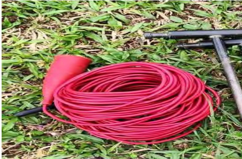
Gambar 3.3 : Kabel Penghubung Elektroda Bantu 1
