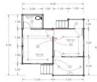
AR Denah Instalasi Listrik Cottage Tipe 2 SKALA 1 : 75
