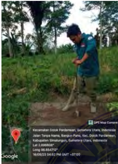
Pengambilan sampel tanah sedalam 30 cm menggunakan alat bor tanah
