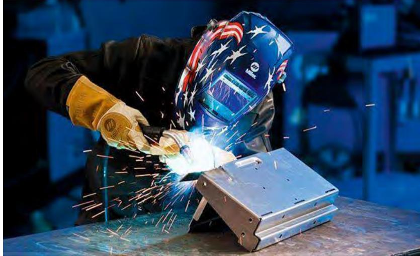
Gambar 2. 16. Proses Pengelasan MIG
