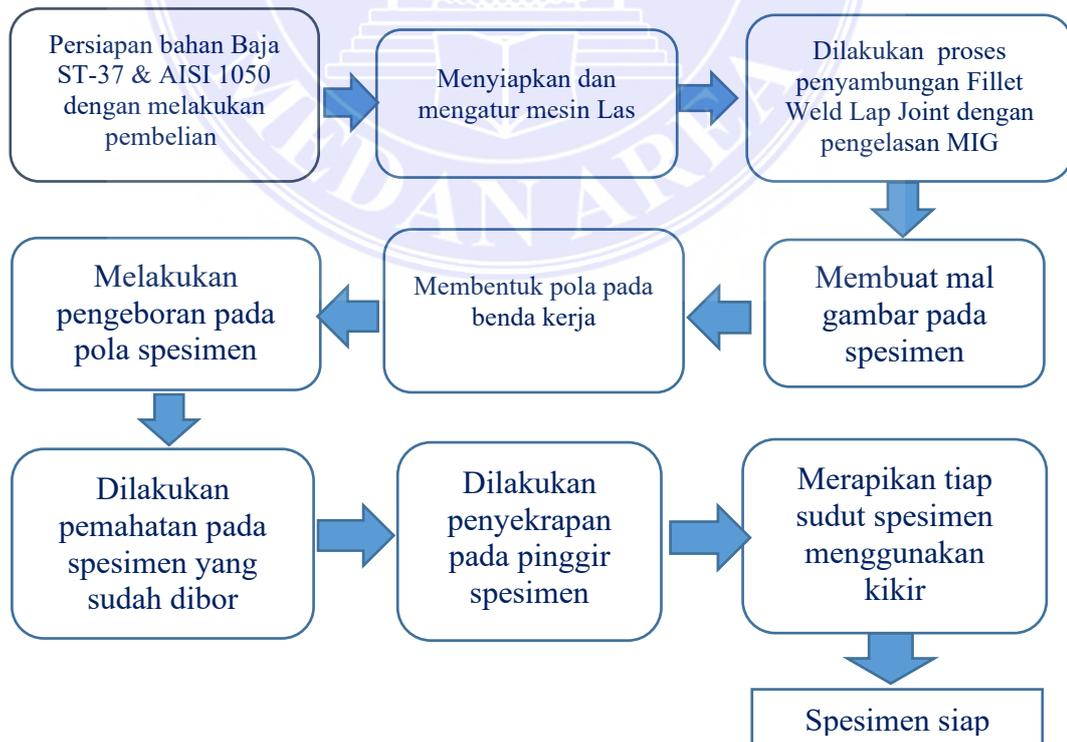
Gambar 4. 1. Diagram Alir Pembuatan Spesimen
