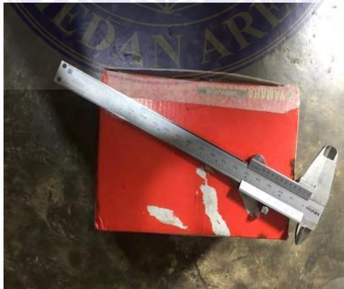
Gambar 3.4. Vernier caliper atau jangka sorong.
