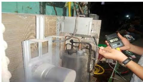
Gambar 3 menunjukkan perhitungan refrigerant masuk dan keluar kondensor menggunakan alat thermokopel
