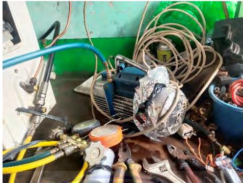
Gambar 1 menunjukkan pompa vakum yang menyerap sisa redrigerant di kondensor ac split
