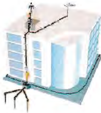
Gambar V.6.8. Penangkal petir sistem Thomas) (sumber : Dwi Tangoro, 2000, hal : 92)
