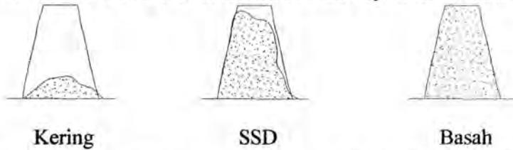
Gambar 3.1 ilustrasi penurunan Agregat dgn berbagai kondisi
