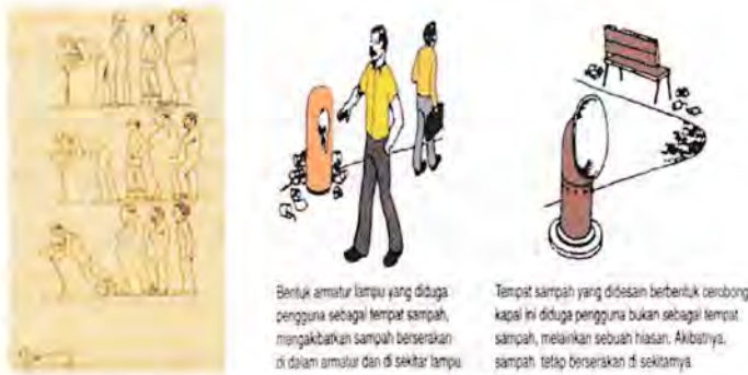
Gambar 22. Akibat perilaku pengguna
