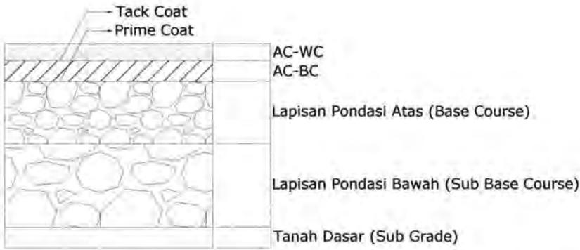
Gambar 2.7 Perkerasan dengan menggunakan Tack Coat dan Prime Coat
