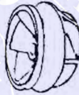
Gambar 2.14. Impeller tertutup Impeller tertutup
