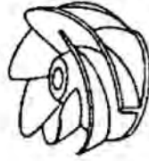
Gambar 2.13. Impeller setengah terbuka
